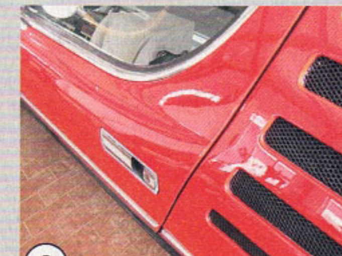
2 ...Länge rostgefährdet, vor allem bei verstopften Abläufen. Grund: Durch die Zierschlitze...
