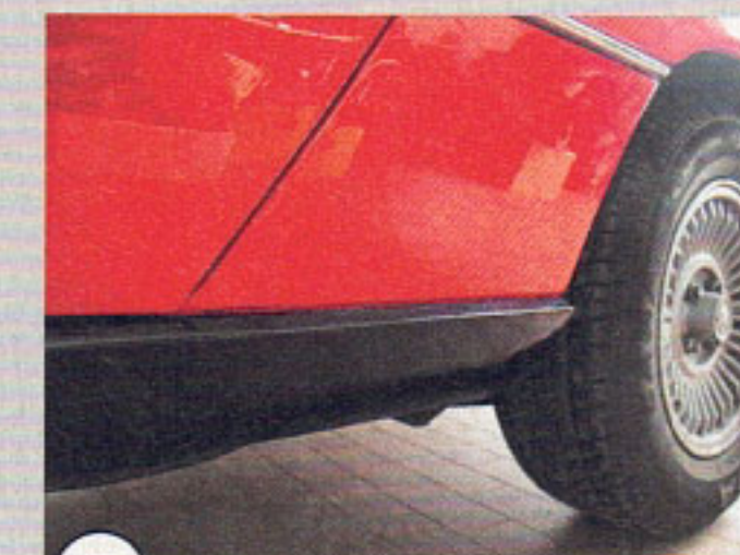
3 ...dringt Wasser ein, das am Seitenteil herunterläuft und sich im Schweller sammelt
