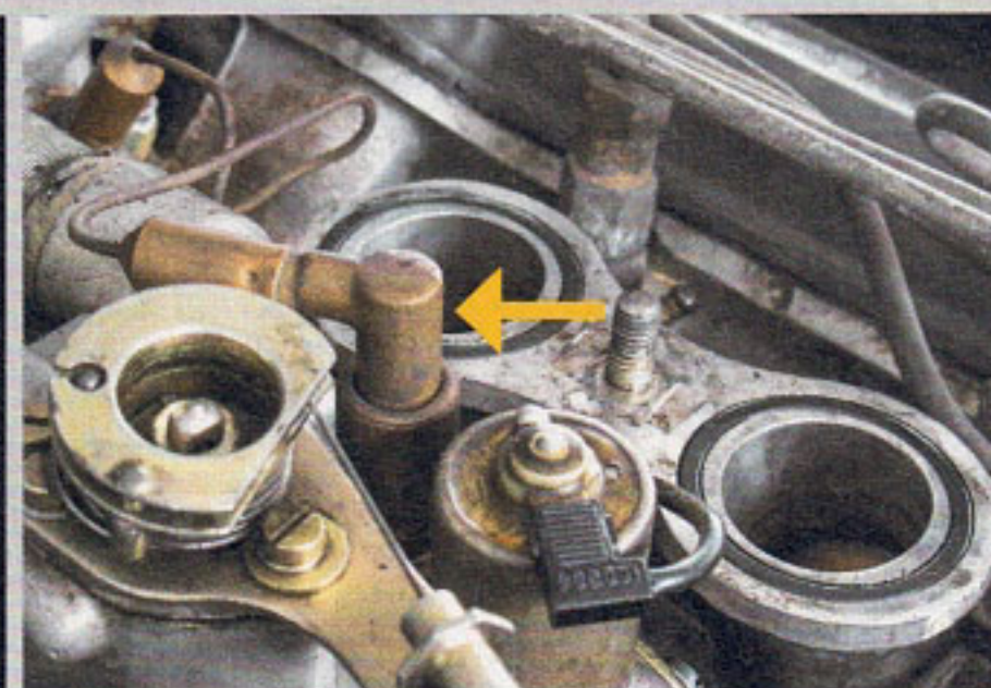
Bis zu 3000 Euro verschlingt die Überholung der Spica-Einspritzanlage. Ihre Hauptfeinde sind Öl-mangel wegen eines verstopften Filters, Benzinverdünnung des Öls – und „Bastler“. Wird der Kaltstart zum Geduldsspiel, ist der für Gemischanreicherung zuständige Temperaturfühler defekt (Pfeil)
