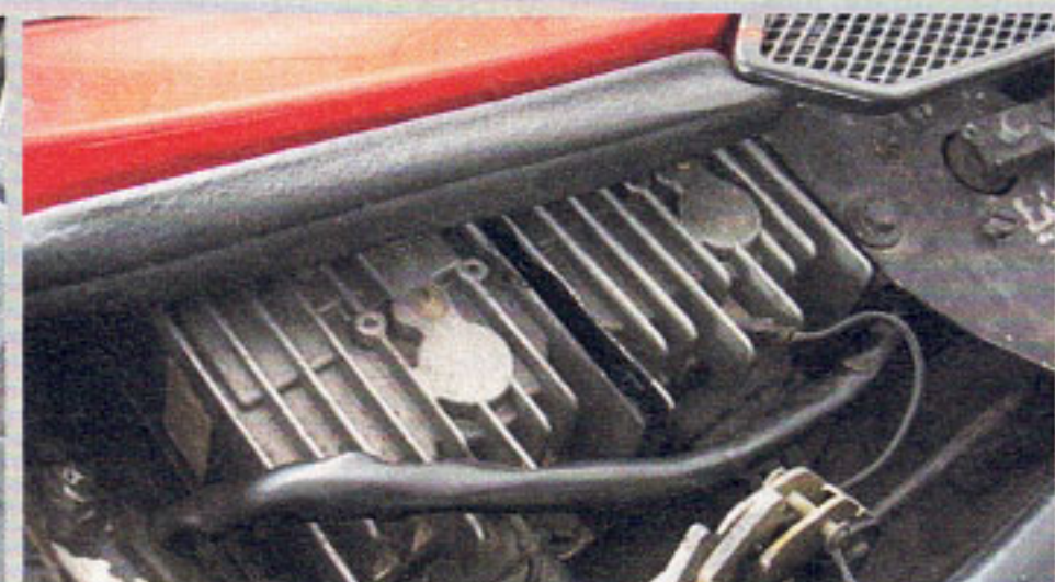
Ist die Dichtung oberhalb der Zündsteuergeräte hin? Dann drohen Wassereinträge
