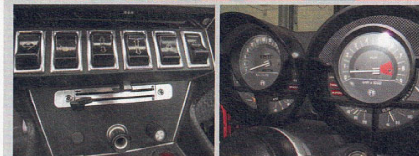
Während die Blende der Mittelkonsole oft Risse zeigt, gibt sich das bizarre Armaturenbrett im Flash-Gordon-Stil sehr UV-fest. Es gilt: Das Interieur muss vollständig und sollte gut sein
