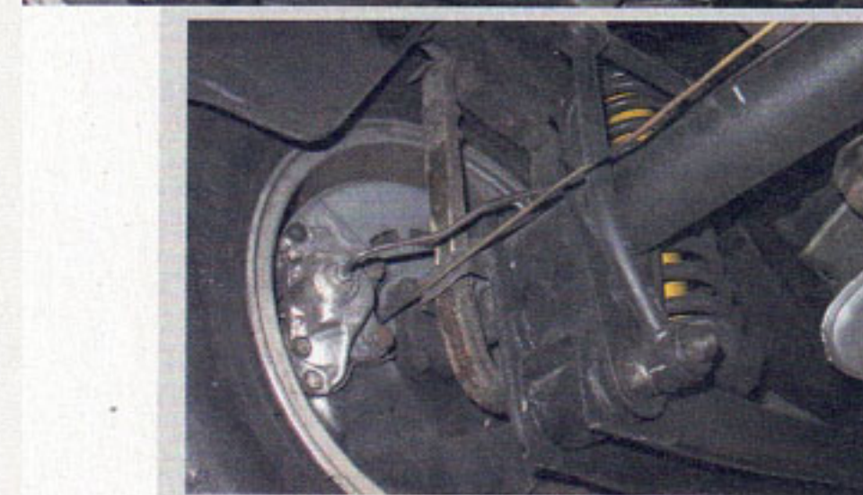
Fahrwerksbuchsen und -bauteile stammen überwiegend aus dem Giulia-Regal und sind entsprechend gut verfügbar – im Gegensatz zu den zisierten Monti-Alurädern. Das Lenktriebegehäuse ist überfordert und reißt oft, kann aber geschweißt und verstärkt werden
