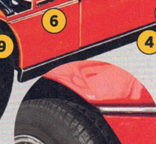
6 Unter der VA-Zierleiste kann es rundum gammeln, ausgehend von den Halteclipsen
