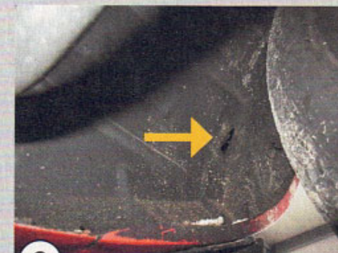
9 Die Radhäuser stehen rundum auf dem Prüfstand. Vorn rechts fand sich ein Loch (Pfeil)
