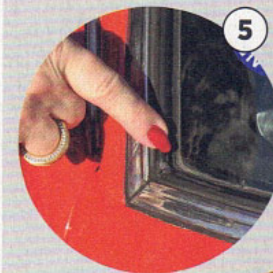
1 Unter den Einstiegsblenden gammeln die Schweller besonders gern, sie sind aber auf ganzer...
