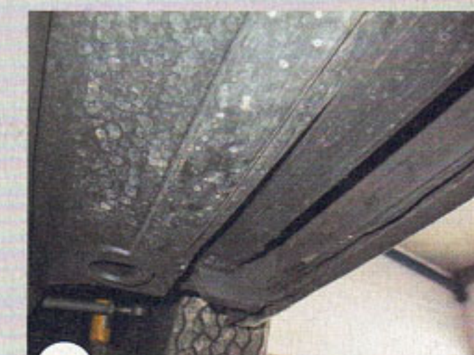
11 ...Blechpartien gilt der Unterboden des Montreal als relativ rostresistent
