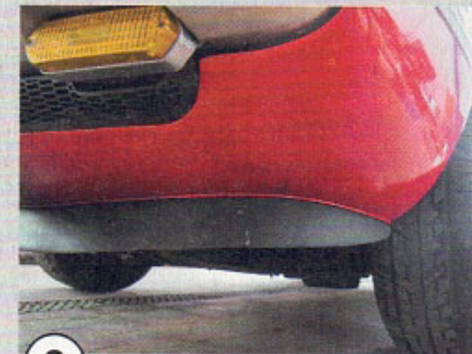
8 Korrosion, vor allem aber Unfälle können der Frontschürze zugesetzt haben
