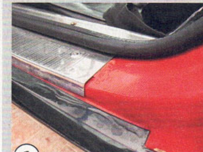
1 Unter den Einstiegsblenden gammeln die Schweller besonders gern, sie sind aber auf ganzer...
