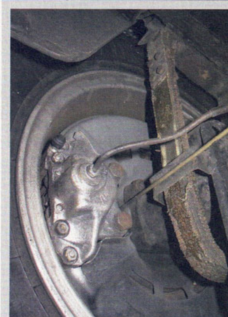
Die zahnlose Bremsanlage basiert im Grunde auf jener der Giulia, nur mit innenbelüfteten Scheiben. Erst die letzten gut 200 Exemplare verzögerten dank großem ATE-Bremskraftverstärker (oben im Bild der kleine) adäquat
