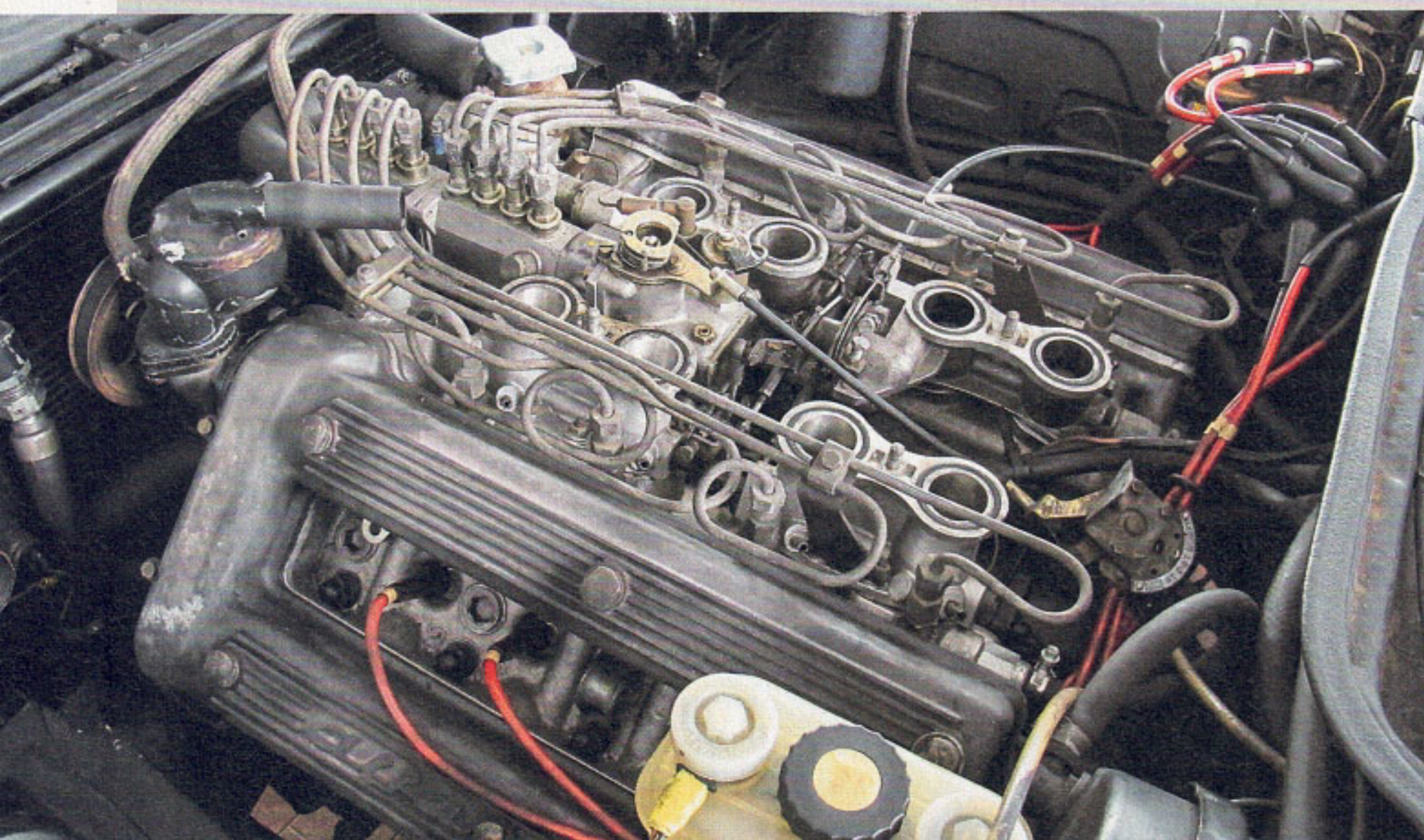
Grande Complication: Eine Kernsanierung des Rumpfmotors verschlingt trotz nasser Laufbuchsen schnell an die 20.000 Euro. Einmal gut gemacht, ist für bis zu 200.000 Kilometer Ruhe
