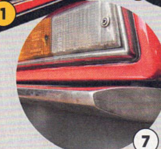
7 Fault es unterhalb der Rückleuchten, sind deren Dichtungen malad und lassen Wasser eindringen
