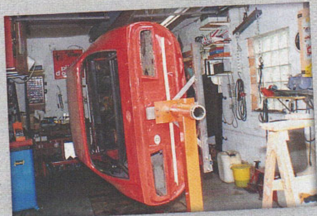
DANK EINES SOLIDEN, SELBSTGEBAUTEN DREHGESTELLS GEHEN DIE ARBEITEN AM UNTERBODEN IN DER GARAGE GUT VORAN
