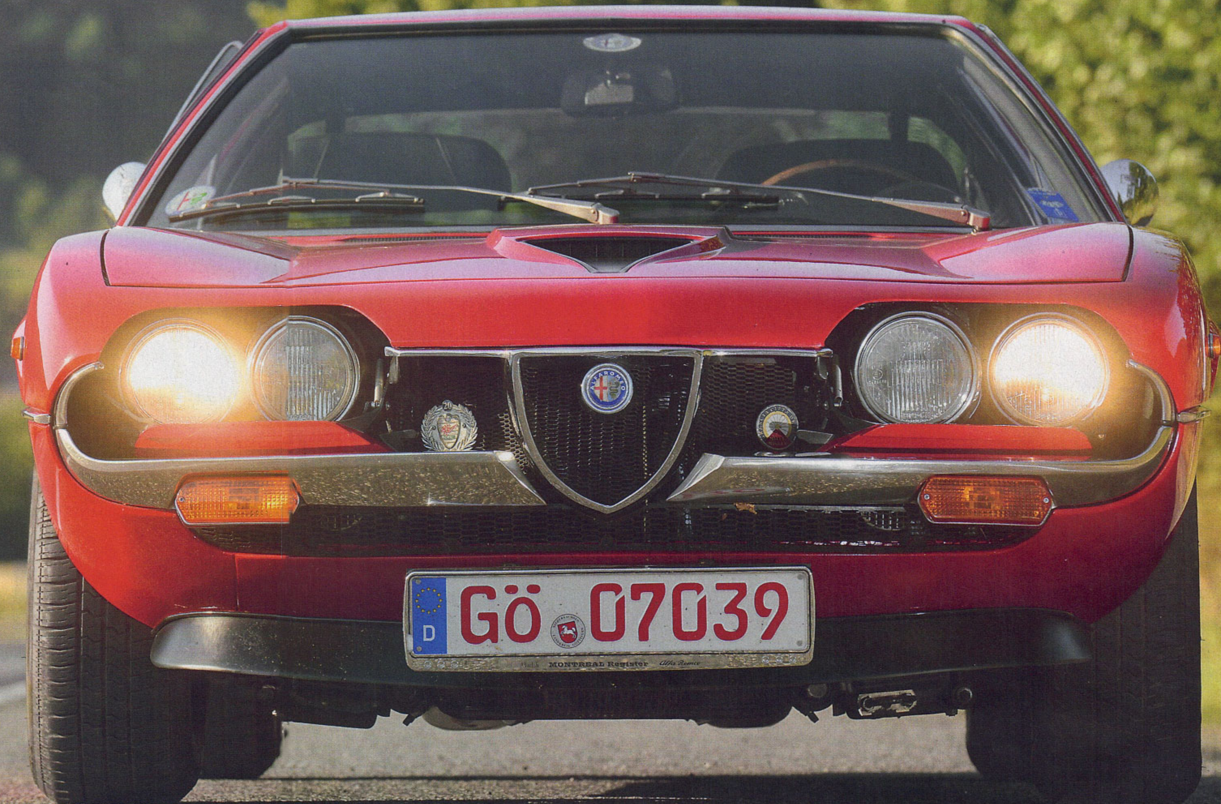
Keine Stoßstange stört die dynamische Front – der Naca-Lufteinlass mitten auf der Motorhaube ist allerdings nur Attrappe. E-Lüfter sorgen dafür, dass es darunter nicht zu heiß wird
