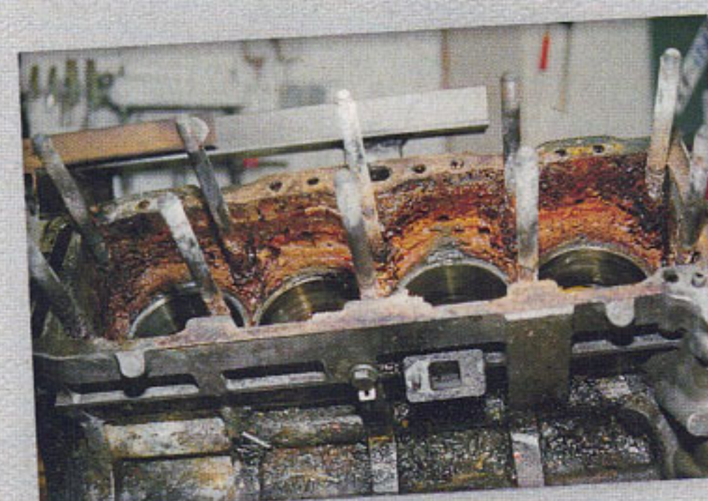
BLOCK-BILDUNG: NACH DER DEMONTAGE DER LAUFBUCHSEN MUSS ERST MAL DER FESTVERKRUSTETE FROSTSCHUTZ RAUS
