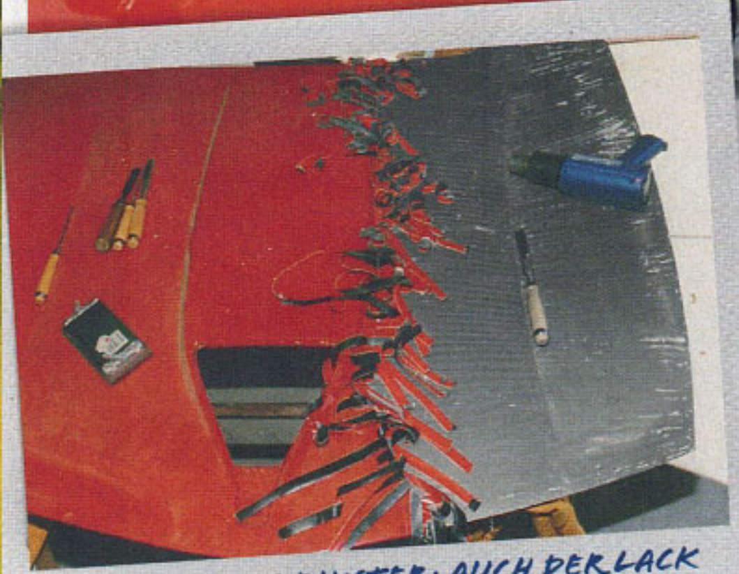
DA KOMMT WAS RUNTER: AUCH DER LACK DER MOTORHAUBE MUSS MIT HEISSLUFT UND VIEL HANDARBEIT ABGELÖST WERDEN
