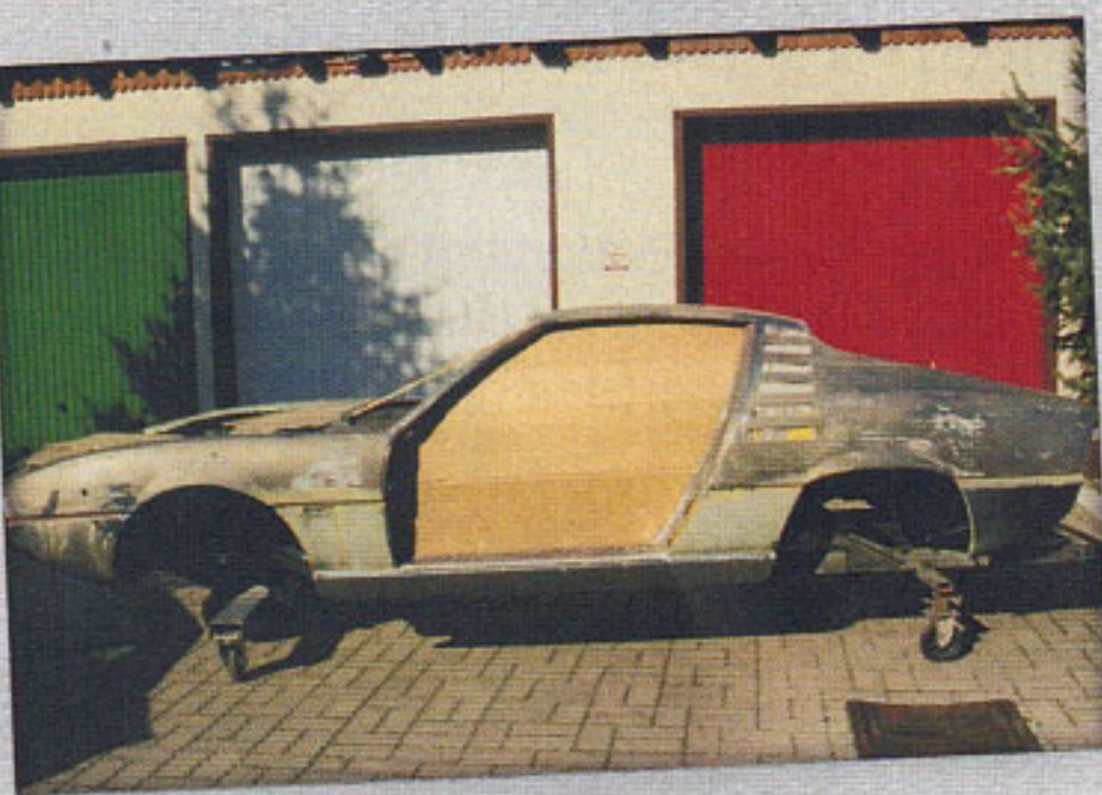
DER GESCHWEISSTE ROHBAU OHNE LACK: DAS „ROSSO 521“ IST MIT HEISSLUFTPÖN UND STECHBEITEL MÜHSAM ENTFERNT
