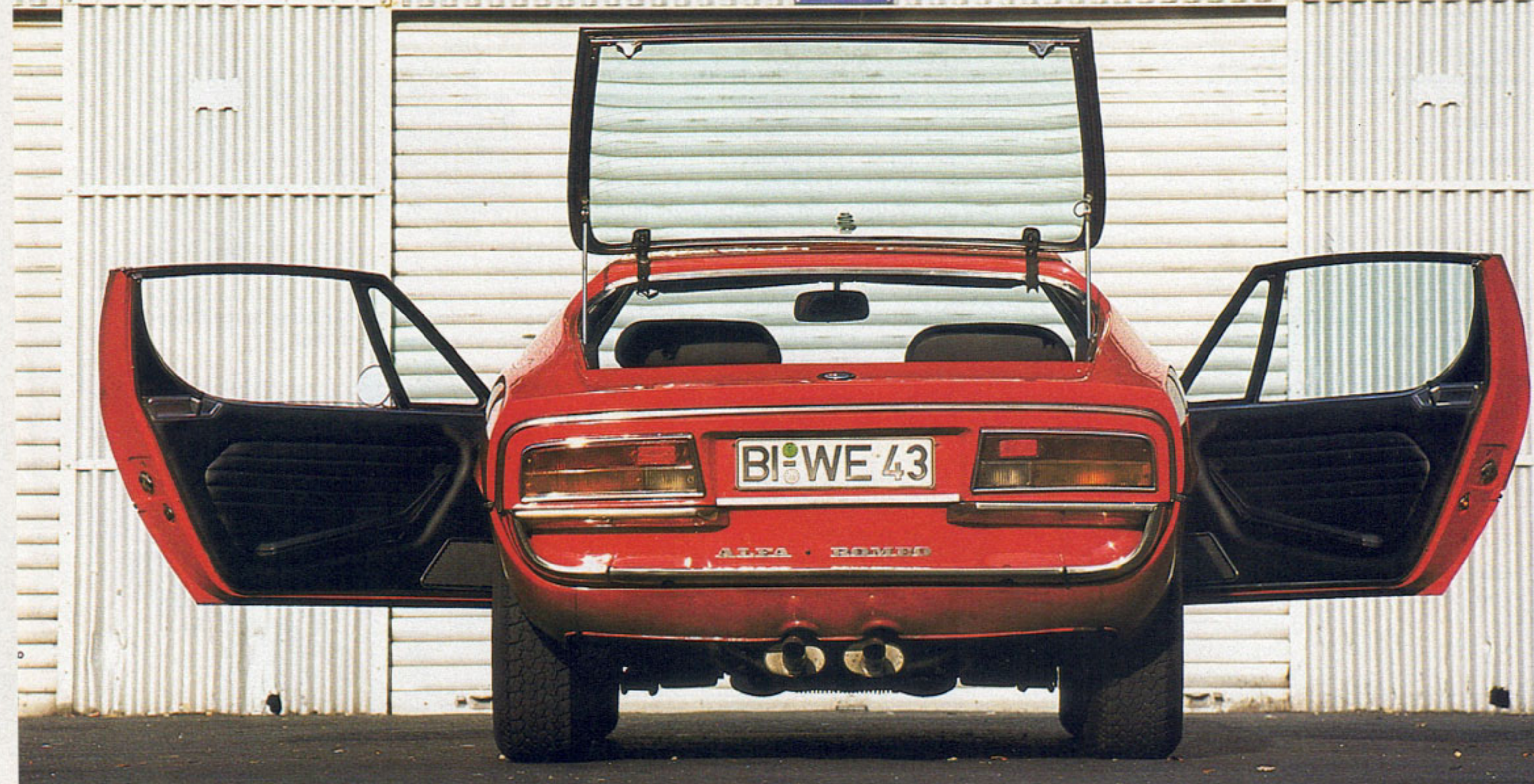
Die großen Türen mit der unverwechselbaren Form sind genauso schwer, wie sie aussehen. Mit 1270 Kilo ist der Montreal denn auch alles andere als ein Leichtgewicht. Die große (Heck-)Klappe verspricht mehr Kofferraum, als sie halten kann: Das Reserverad läßt nur ein winziges Gepäckabteil übrig.
