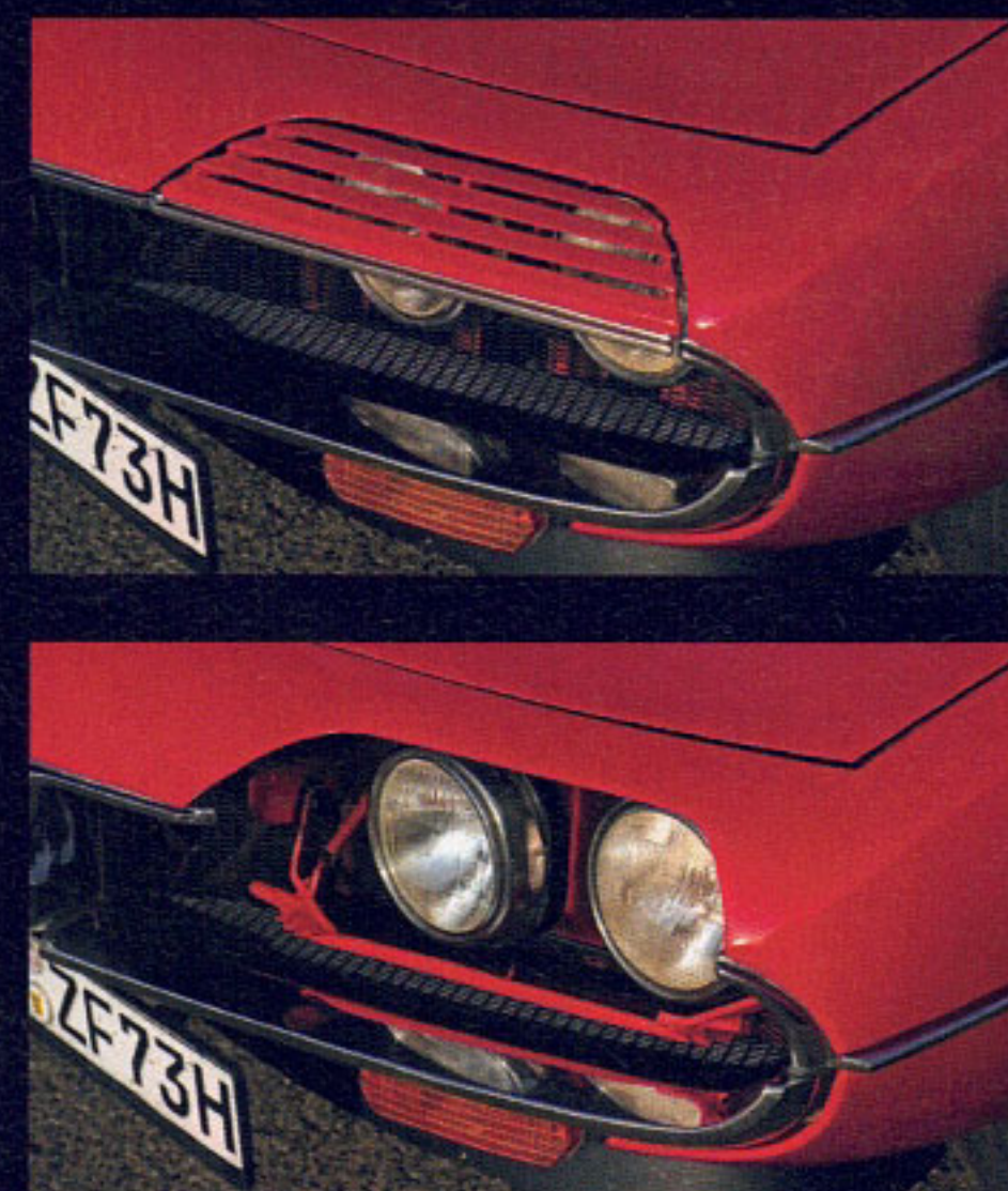
Die durchbrochenen Scheinwerferblenden klappen beim Lichteinschalten per Unterdruck nach unten
