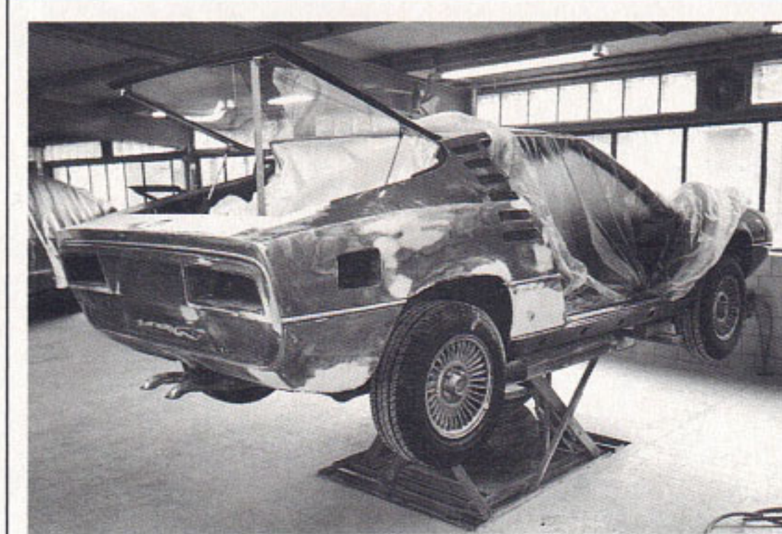
Mehr Arbeit als erwartet Die Hoffnung, nur unterhalb der Gürtellinie lackieren zu müssen, vereitelten die Rostnester am oberen Heckblech. Immerhin konnte Alexander Keichel den alten Lack auf Dach, Motorhaube und Teilen der Türen retten
