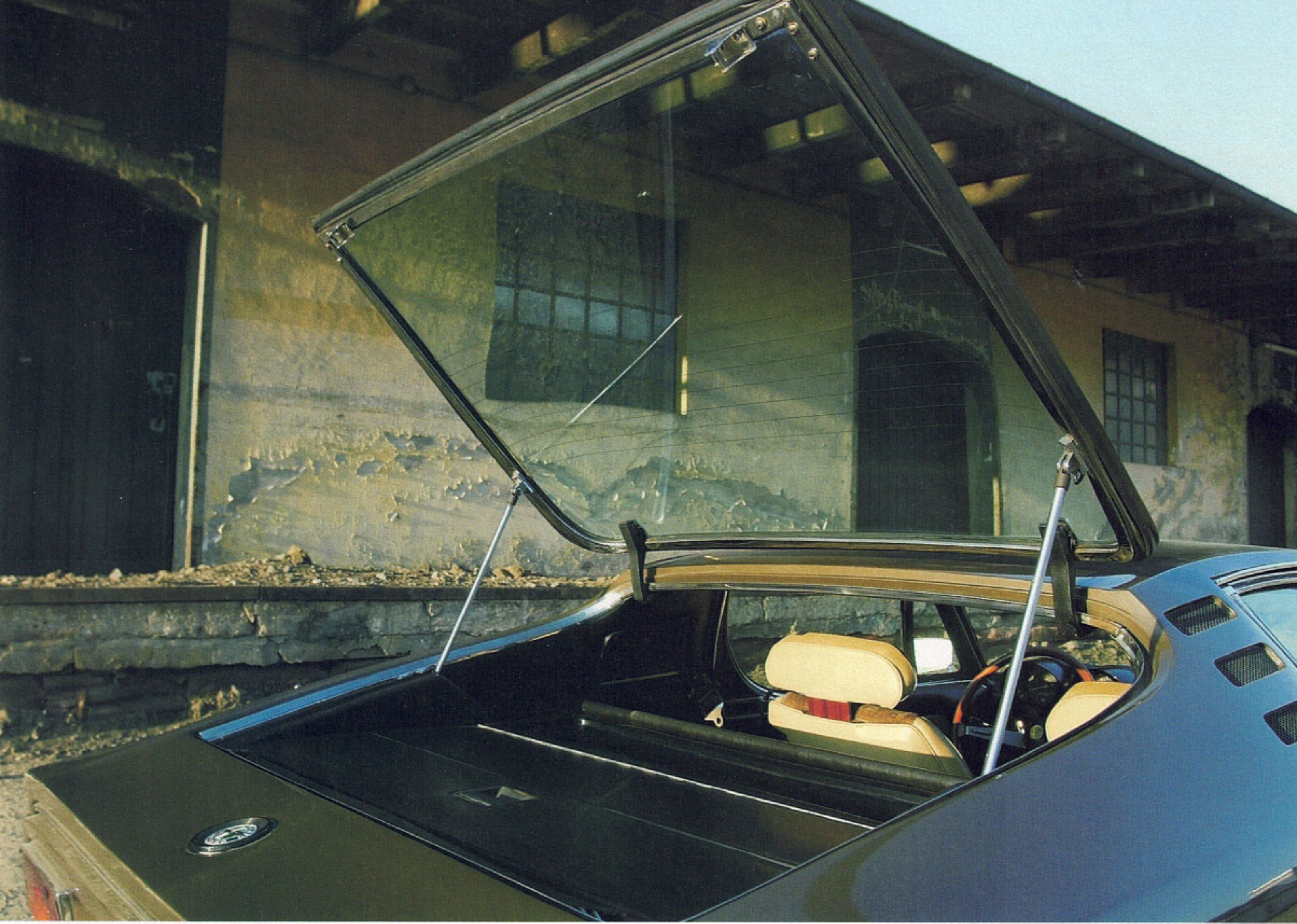
Die Klappe ist groß – und eine gewagte Konstruktion, die nie dicht war
