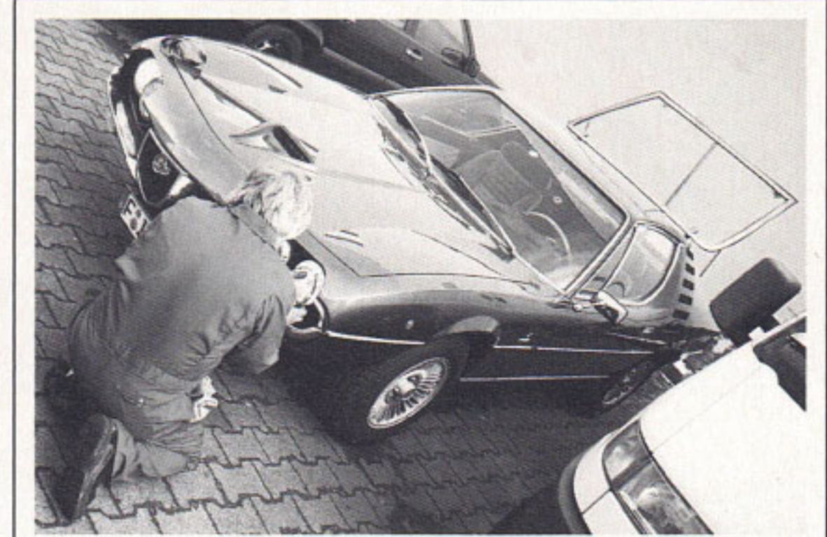
Augen auf per Knopfdruck Die Jalousien vor den Scheinwerfern öffnen und schließen nicht per Elektromotor, sondern mit Unterdruck. Im Motorraum kann man vorwählen, ob sie beim Einschalten des Lichts abklappen sollen oder nicht
