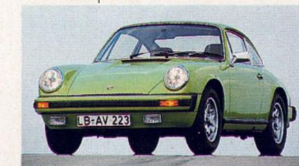
Sechszylinder-Boxermotor, Bohrung x Hub 90 x 70,4 mm, Hubraum 2687 cm<sup>3</sup>, Leistung 175 PS bei 5800/min, Bauzeit 1973 bis 1975, Stückzahl 7904.
