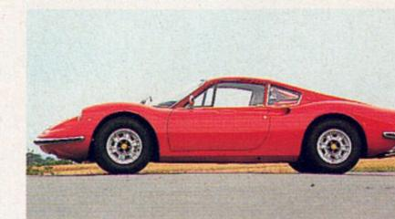
Sechszylinder-Viertaktmotor, Bohrung x Hub 92,5 x 60 mm, Hubraum 2418 cm<sup>3</sup>, Leistung 195 PS bei 7600/min, Bauzeit 1969 bis 1974, Stückzahl 2609 (ohne GTS).
