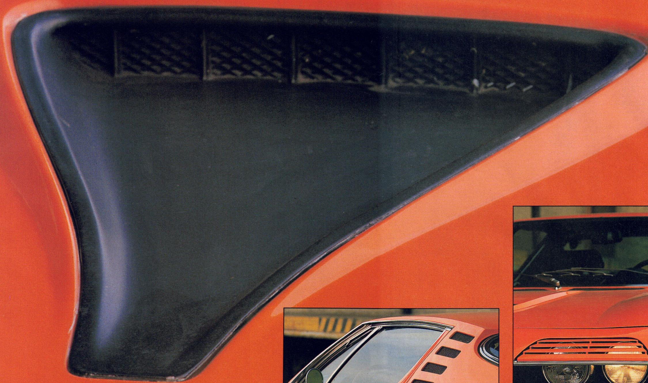
Gegenüber der Urversion von 1967 wurde bei der Serienausführung des Montreux die Anordnung von Lüftungsschlitzen auf der Motorhaube durch einen zentralen Lüftungslatz ersetzt (großes Foto), nur die Lüftungsschlitze an der B-Säule sind geblieben. Einziges Stylingelement sind die Jalousien über den Scheinwerfern, die auf Wunsch pneumatisch nach unten klappen.
