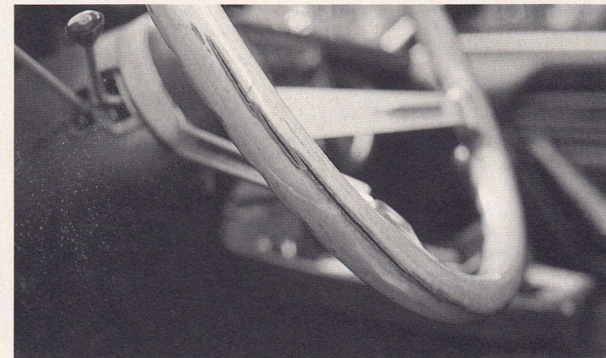
Bei tiefen Rissen muß das Montreal-Holzlenkrad neu angefertigt werden
