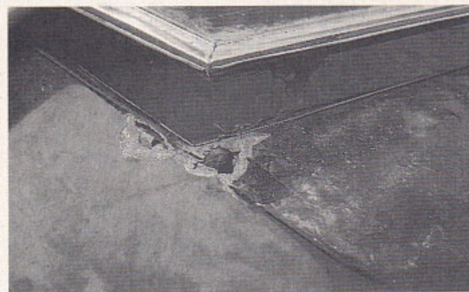
Rost im Bereich der Ecke des Heckscheibenrahmens.
