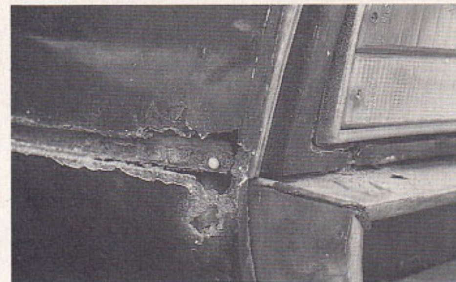
Rost unter den Zierleisten, wie hier seitlich hinten.
