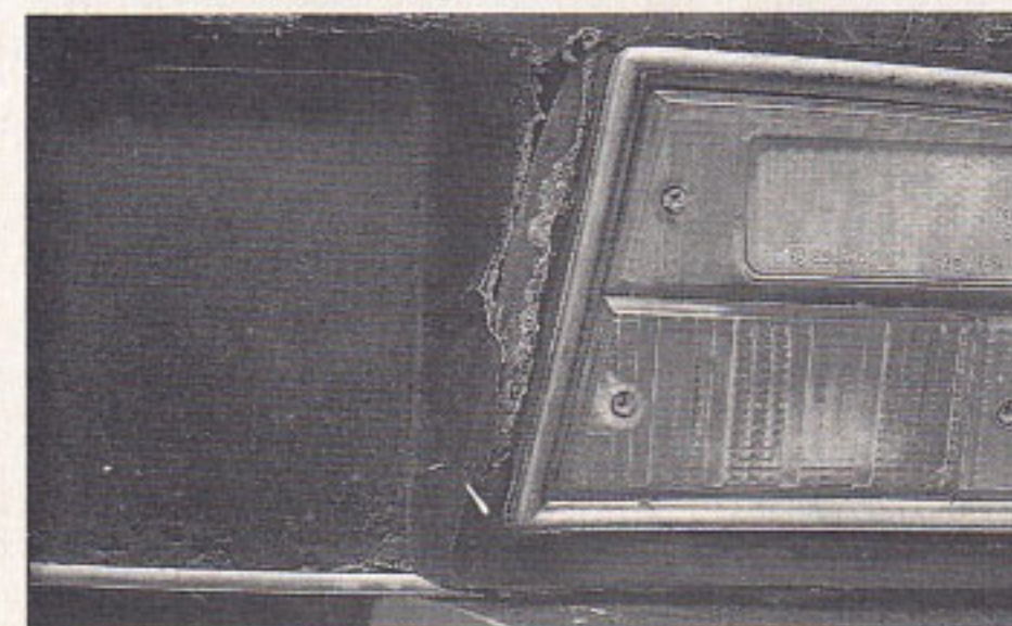
Rost am Heckblech, speziell um das Rücklichtgehäuse.
