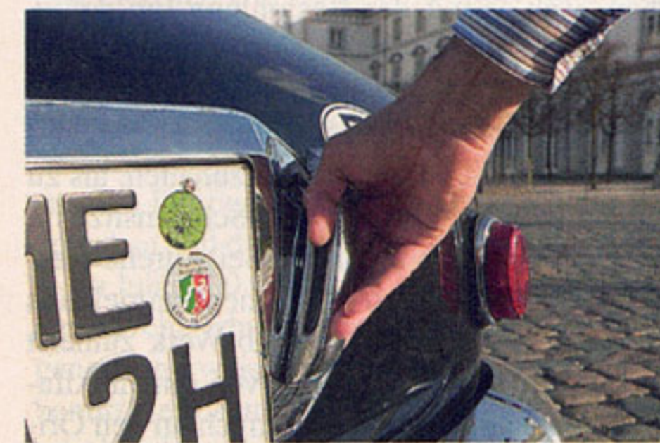
Versteckte Haubenöffner – auf dass nichts das glattflächige Blechkleid verunstalten möge
