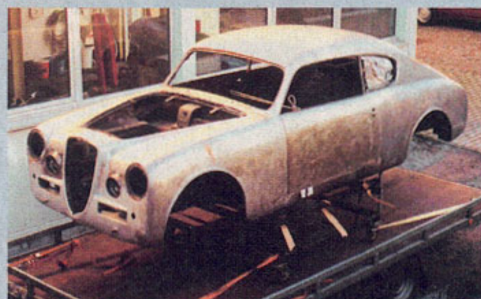
Absolut ungeschweißt: Die Karosserie des B20 GT präsentierte sich hervorragend erhalten
