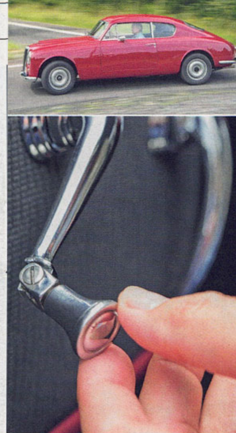
Als anderen Autos spitze Flossen wuchsen, übte sich Lancia in asketischer Eleganz: schlichtes Blech-Cockpit, filigranes Lenkrad, aber wunder-volle Details wie die klappbare Fensterkurbel, damit man sich nicht stößt
