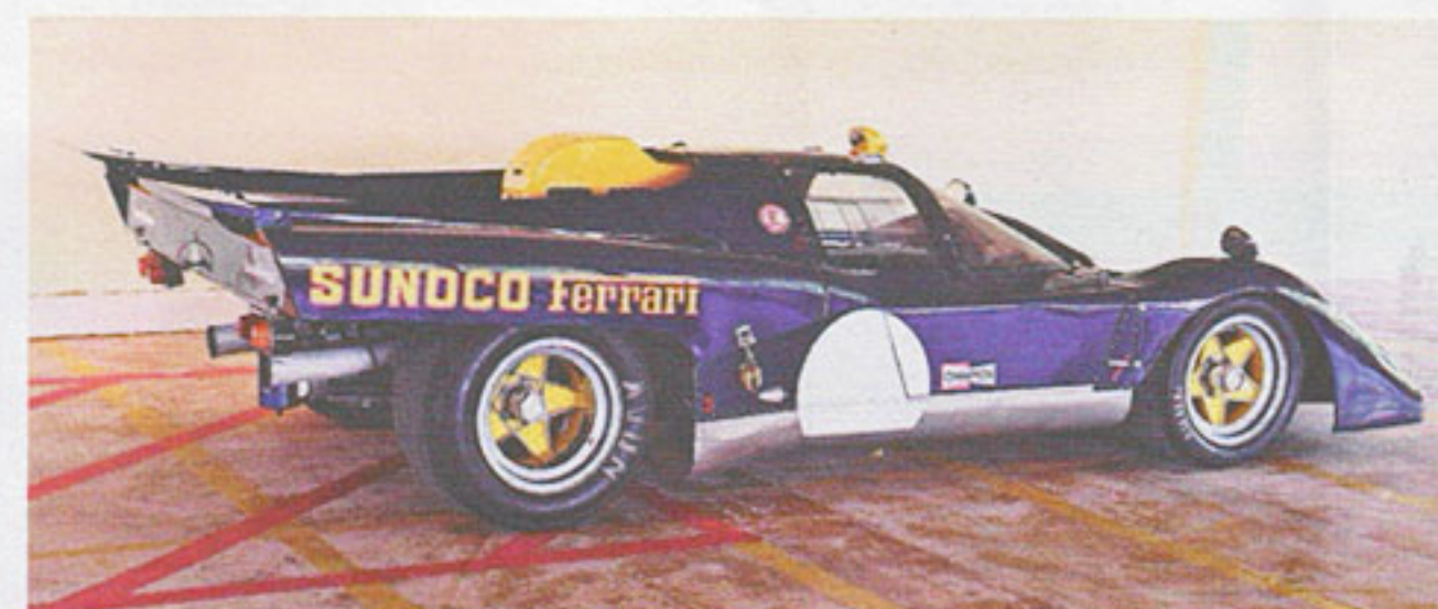
Der Ferrari 512 M hat einen 5-Liter-V12-Saugmotor im Heck installiert. In Sunoco-Farben kam er in der CanAm zum Einsatz.
